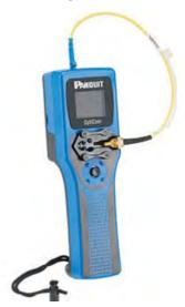
Figure 4-8 Panduit OptiCam Tool
